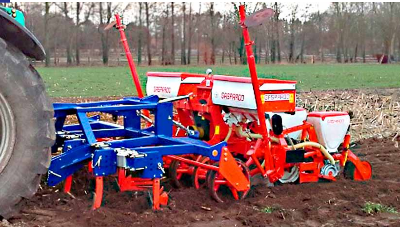
Dammax 4 mit angebauter Sätechnik
