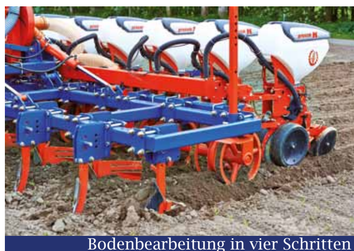
Dammax 4 mit angebauter Sätechnik
